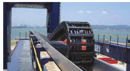
CF9 na venkovním jeřábu. Energetický řetěz: systém E4/00
