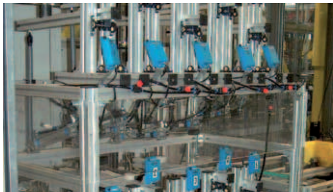
Obrázek 12: Testovací stolice pro testování opotřebení při kývavém pohybu pro malá zatížení
