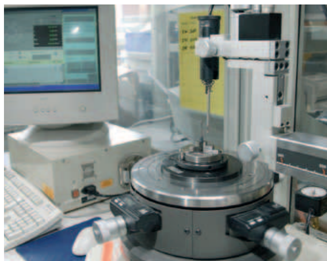
Obrázek 14: Měření vnitřního průměru kluzných pouzder iglidur®
