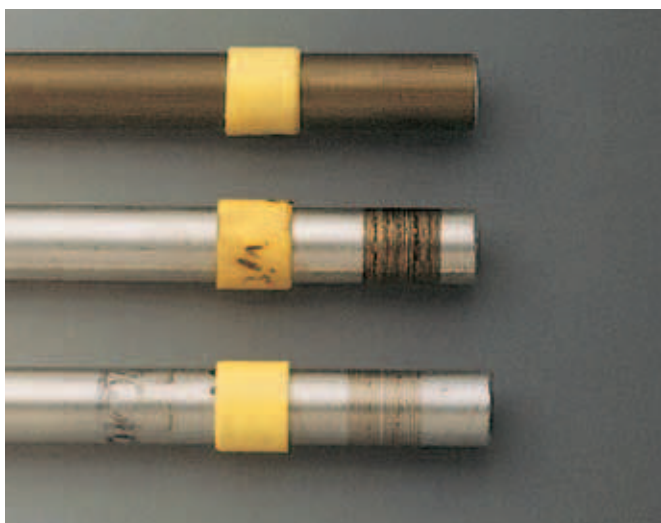
Obrázek 10: Testy opotřebení s hliníkovými hřídelemi
