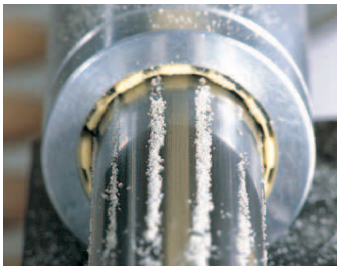
Obrázek 09: Vysoká odolnost proti opotřebení: Kluzné ložisko v kontaktu s pískem
