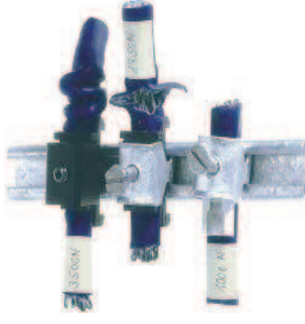
igus® test: Porovnání tří různých omezovačů tahu - Výsledek: trojnásobná tahná síla v porovnání s konvenčními produkty.
