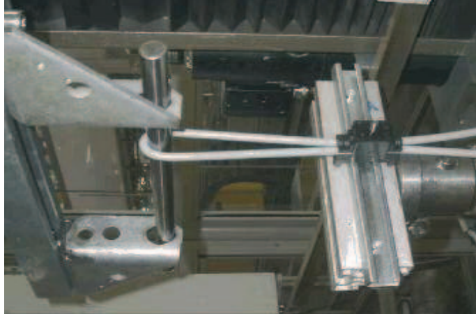
igus® tahový test s CFX svorkami
