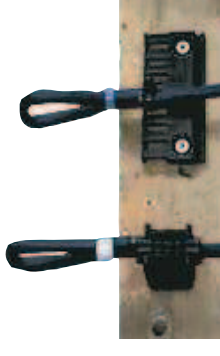
Test tahové síly s kabely chainfix®
