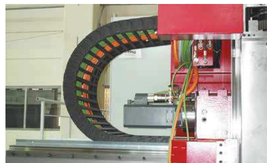
Systém osazených energetických řetězců readychain® v obráběcím stroji. Energetický řetěz: Systém E4/4
