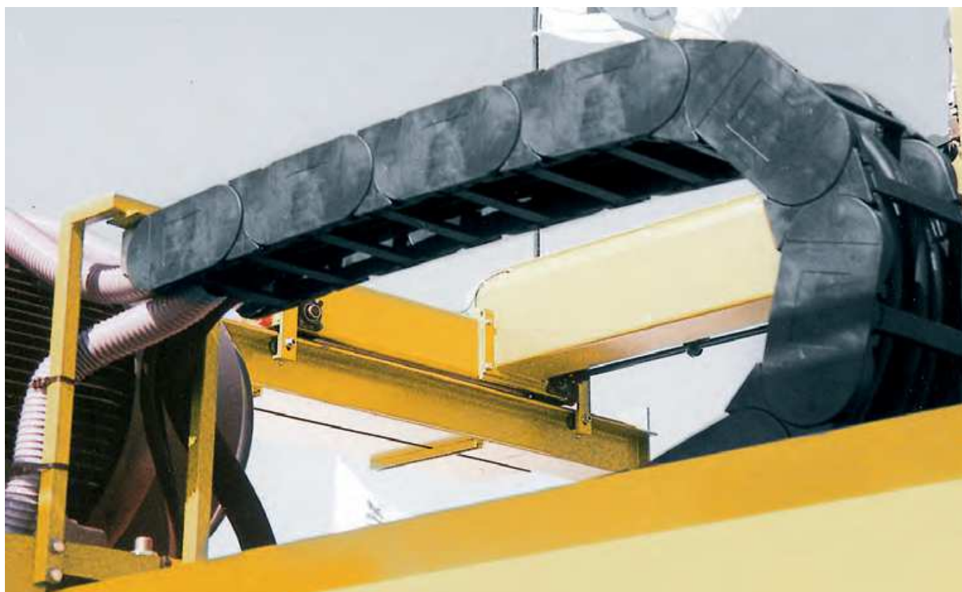
System E4 e-chain® - může být naplněn kabely o průměru až 100 mm
