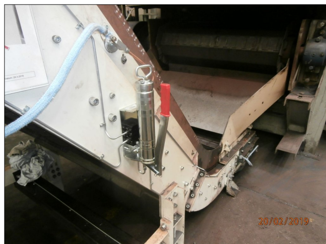
Čerpadlo HP 500 W-SSV s integrovaným progresivním rozdělovačem
