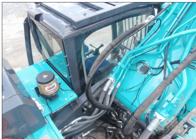
Čerpadlo P203 (vlevo) a progresivní rozdělovač SSVD (vpravo)
