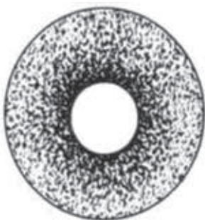
průřez „RTEC“ znázorňující stupňující se hustotu konstrukce
