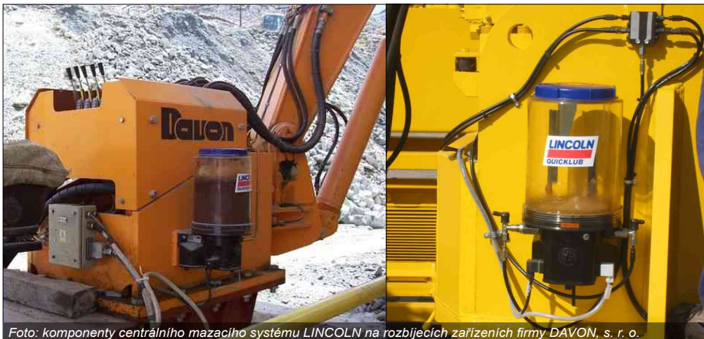
Foto: komponenty centrálního mazacího systému LINCOLN na rozbíjecích zařízeních firmy DAVON, s. r. o.
