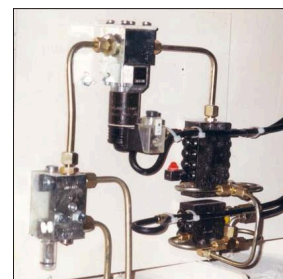
2-2 cestné elektromagnetické ventily pro připojování a odpojování jednotlivých větví systému
