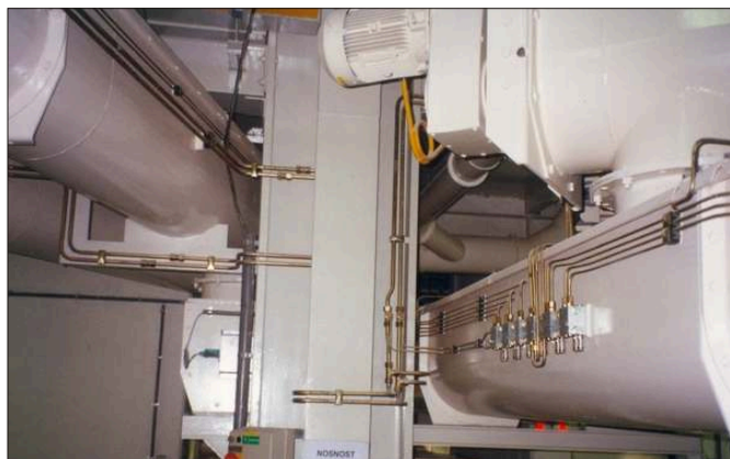
Část technologického zařízení s mazacím systémem
