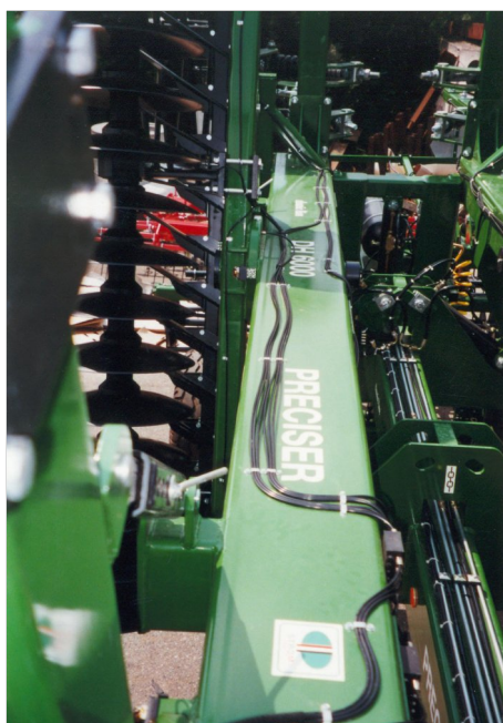
Sekundární progresivní rozdělovače a rozvody
