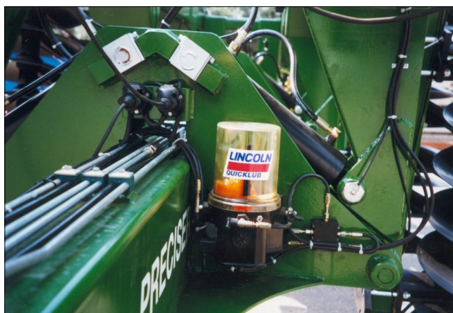
Čerpadlo P203 s primárním progresivním rozdělovačem SSV
