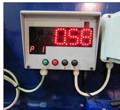
Řídicí jednotka. Aktuálně nastaveno na výdej dávky 0,58 kg uložené pod předvolbou P1.
