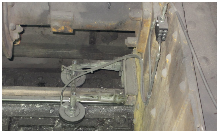
Progresivní rozdělovač a nanášecí kotouče odvalující se po kolejnici
