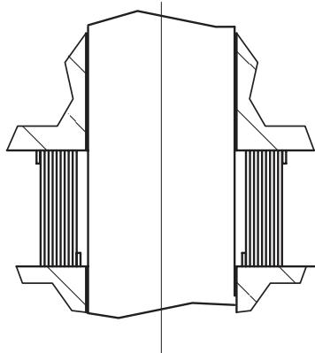
Jsou levným způsobem, jak zafixovat spirálový kryt ke stroji. Jsou vhodné především u nižších rychlostí posuvu (pod 0,5 m/min). Zarážkové čepy nejsou součástí dodávky spirálových krytů.
