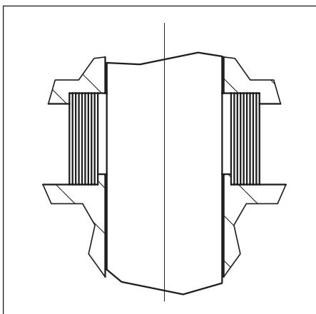
Jsou levným způsobem, jak zafixovat spirálový kryt ke stroji. Jsou vhodné především u nižších rychlostí posuvu (pod 0,5 m/min).
