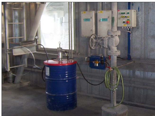
Čerpadlo Lubrigun s pneumatickými ovládacími prvky a elektroovládáním
