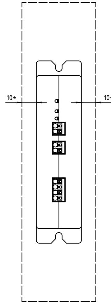
\*Platzbedarf zu benachbarten Bauteilen / Wänden im Schaltschrank
