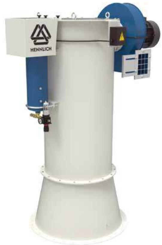
Patronenfilter N1500 V ist eine robuste, druckwiderstandsfähige Zylinder-Filtereinheit für das Entstauben von pneumatisch und mechanisch befüllten Silos oder Übergabestellen.
