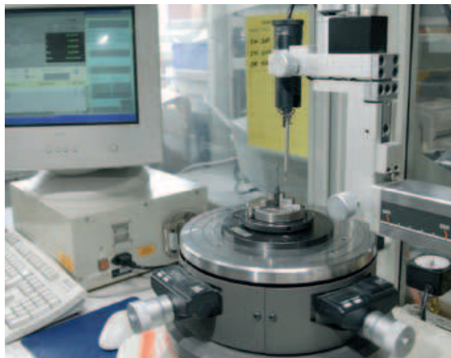
Obrázek 14: Měření vnitřního průměru kluzných pouzder iglidur®
