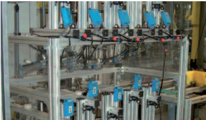
Obrázek 13: Testovací stolice pro testování opotřebení při kývavém pohybu pro střední zatížení
