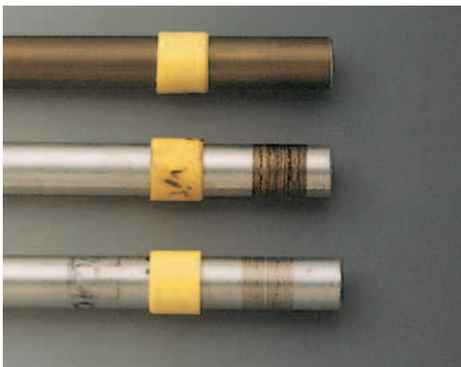
Obrázek 10: Testy opotřebení s hliníkovými hřídelemi
