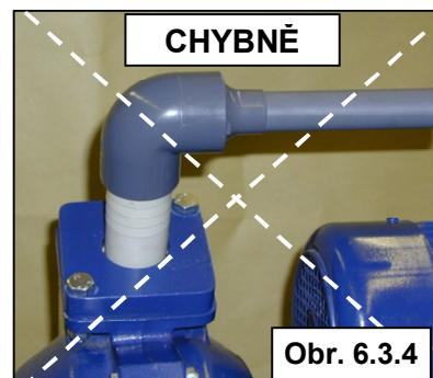
Při instalaci by pro zamezení tlakových špiček, které mohou poškozovat pracovní hadici, **neměla** být namontována 90° kolena či oblouky přímo u čerpadla (viz obr. 6.3.2 a 6.3.3).
