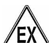
Symbol se v provozním návodu používá k identifikaci bezpečnostních informací vztahujících se ke směrnici 1999/92 / ES (provozní směrnice ATEX), které je třeba při provozu čerpadel dodržovat, např. informace o údržbě.
