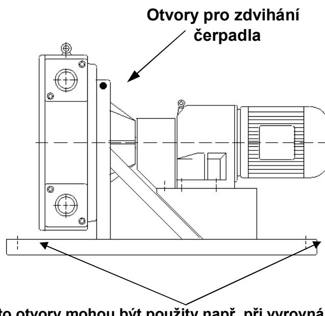
**Tyto otvory mohou být použity např. při vyrovnání čerpadla při zdvihání.**
