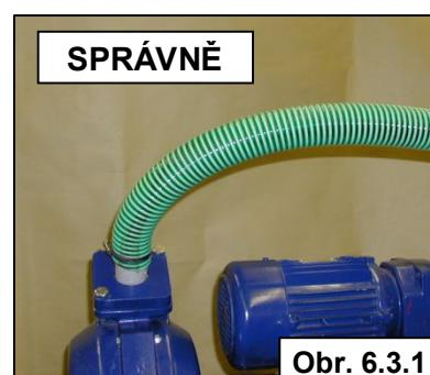
Připojení se standardně provádí ohebnou hadicí a hadicovou sponou, u speciálních provedení např. nápojovým šroubením, spojkou Kamlok, přírubovým spojením apod.
