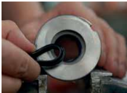
Kroužek oválně tvarovat
