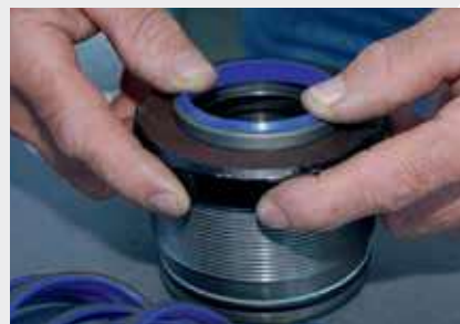
Kroužek uložit přímo do naváděcího úkosu úložného prostoru. Zatlačit objímkou, aby nedošlo k poškození bříty.
