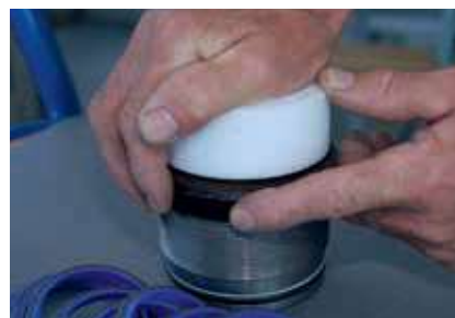
Řešení přípravku pro sériovou montáž. Kroužek se břitem nasadí na čep přípravku, středěného při vytlačování otvorem vývrtu.
