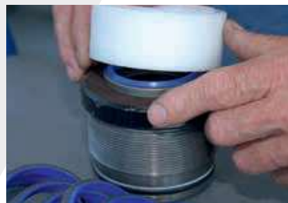
Řešení přípravku pro sériovou montáž. Kroužek se břitem nasadí na čep přípravku, středěného při vytlačování otvorem vývrtu.
