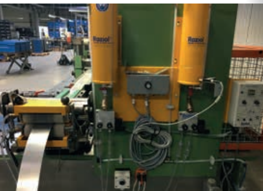
Příklad systému pro celoplošné mazání přístřihů s válečkovým aplikátorem s pohonem, s dopravníkovým stolem
