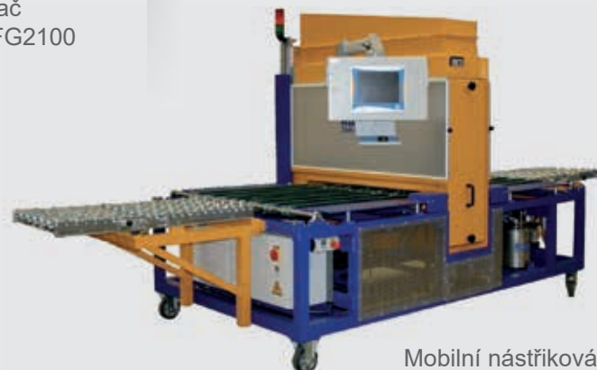
Nástřiková komora Premium SA-P pro mazání přístříhů nebo svitku, s olejovou vanou s integrovaným odsávacem olejové mlhy
