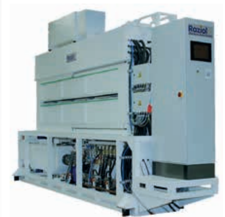
Nástřiková komora Premium SA-P pro mazání přístříhů nebo svitku, s olejovou vanou s integrovaným odsávacem olejové mlhy
