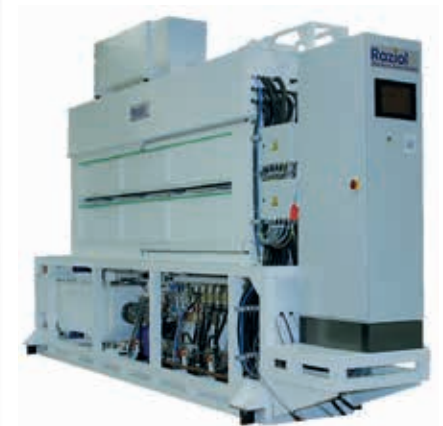
Nástřiková komora Premium SA-P pro mazání přístříhů nebo svitku, s olejovou vanou s integrovaným odsávacím olejové mlhy
