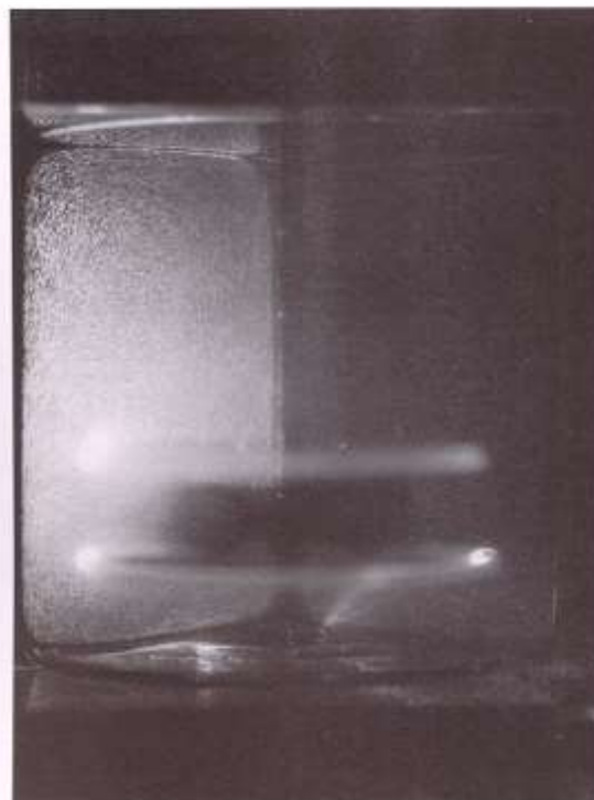
Stabile Luftströme in der VISCO JET Strömung (Seitenansicht)
