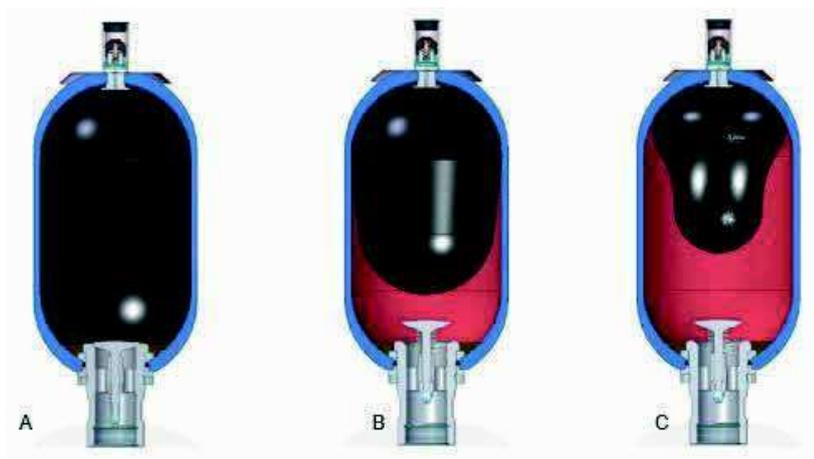
**A.** Vak je předplněn plynem, tj. zatížen jen dusíkem ( $P_0$ ). Olejový ventil je uzavřen a zabraňuje poškození vaku.
