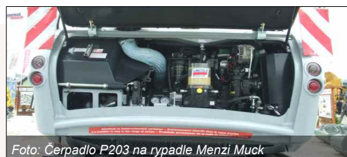
Foto: Čerpadlo P203 na rypadle Menzi Muck
