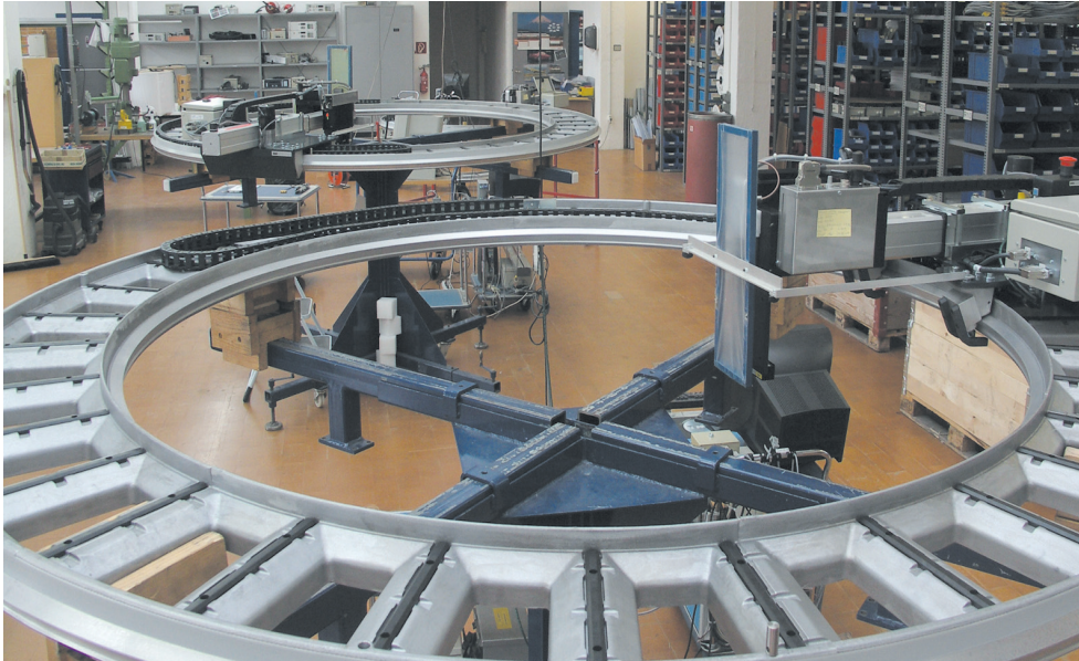
E2 mini e-chain® with Reverse Bend Radius RBR
