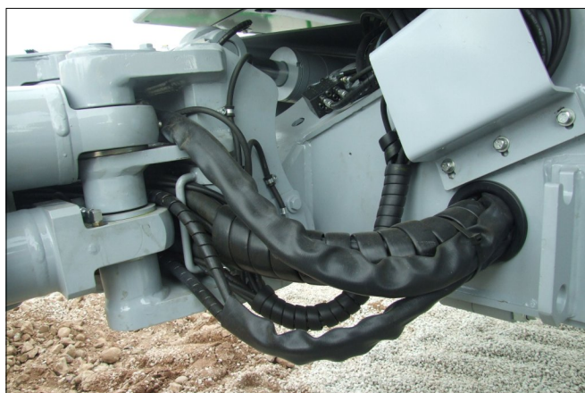
Progresivní rozdělovače (nahore, druhý pod krytem) a přechod hadic hydrauliky a mazání na pohyblivá ramena
