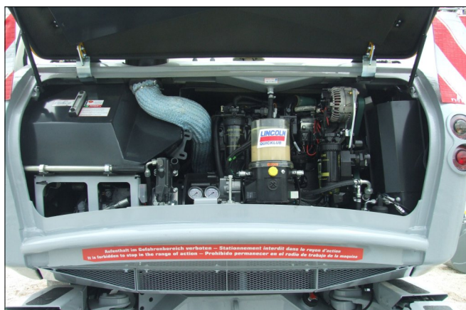
Čerpadlo P203 umístěné v motorovém prostoru rýpadla
