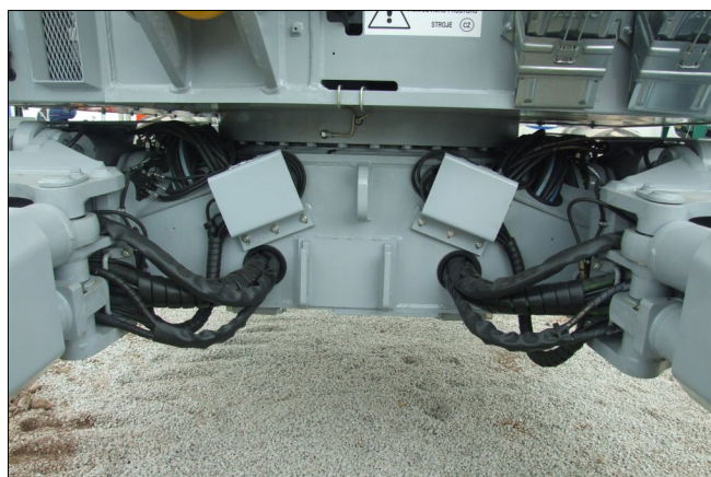
Pohled na podvozek rýpadla z přední strany s progresivními rozdělovači za kryty
