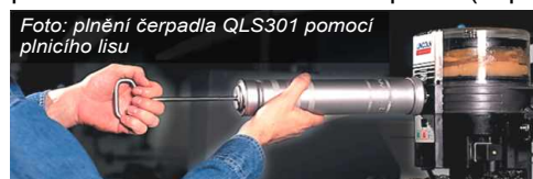
Foto: plnění čerpadla QLS301 pomocí plnicího lisu
