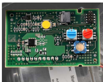
Autonomní ovládání - interní řídicí deska
