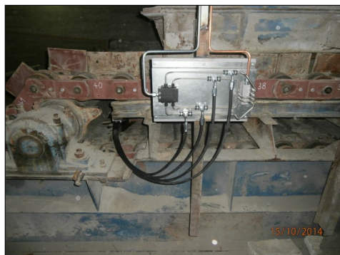
Panel se sekundárním progresivním rozdělovačem a směšováním oleje a vzduchu. Směs oleje a vzduchu je vedena k tryškám flexibilními hadicemi.
