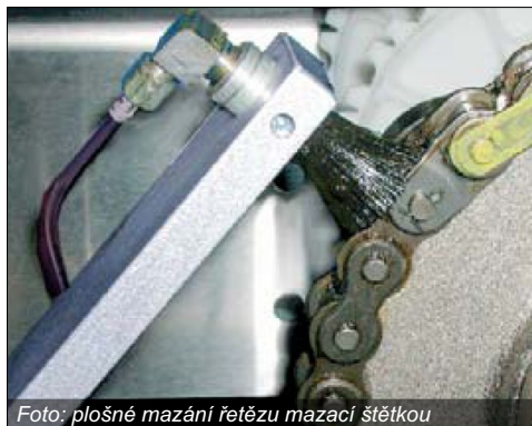
Foto: plošné mazání řetězu mazací štětkou
