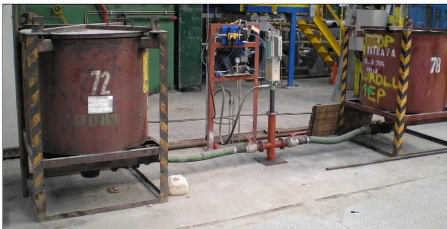
Čerpací stanice s kontejnerovým čerpadlem Power-Master III napojená na dva kontejnery s mazivem
