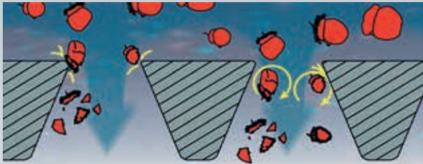
Obr. 2 Rotace ve spáře se zrychlením b = v^2/r larvy zabíjí Bernoulliho filtr
