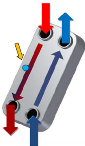
Obr. 2: Obecně doporučený směr proudění ve výměníku tepla a také identifikace primární strany tečkou.
